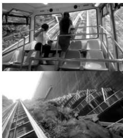
写真1・2 インクラインを活用した昇降機。
